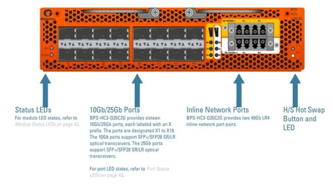
**Figure 12** *BPS-HC3-Q35C2G Module*
